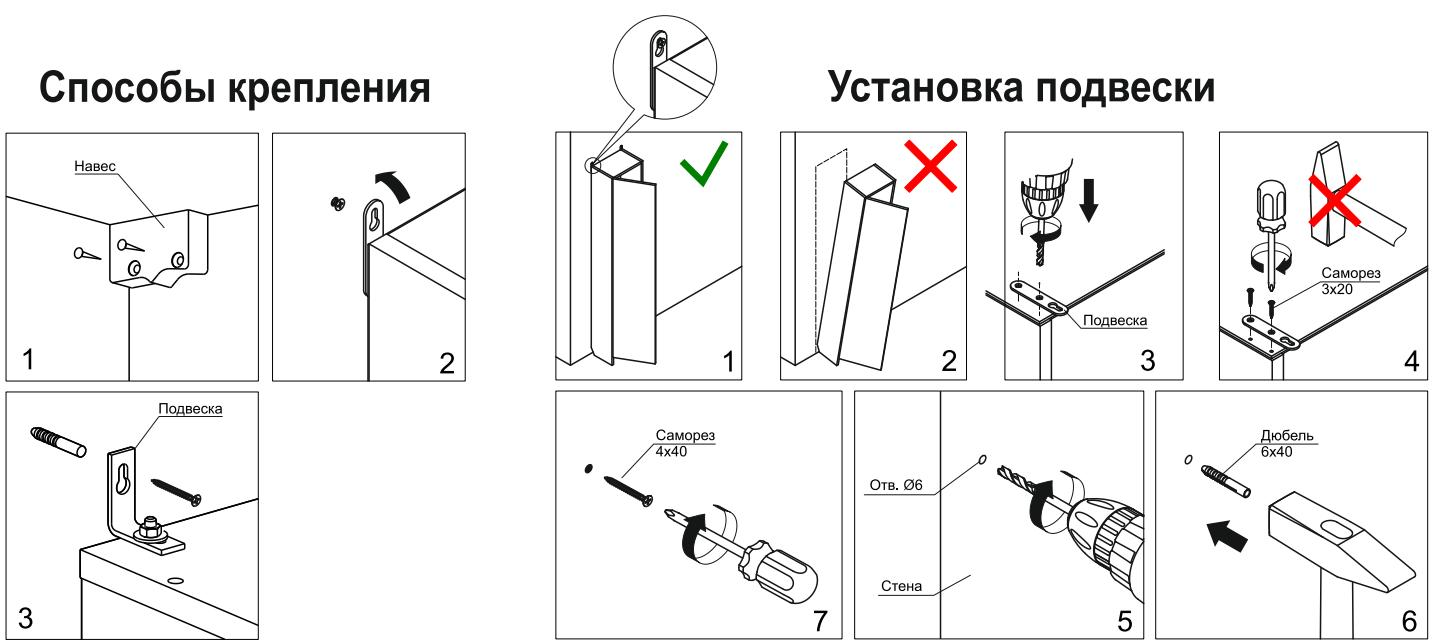
Во избежание опрокидывания изделия во время эксплуатации закрепить его к стене (см. схемы 1, 2). Для разных материалов стен требуются различные крепления, используйте крепёжные средства, подходящие для материала стен в вашем доме. На схемах 3 - 8 показана последовательность крепления изделия к стене с использованием дюбелей.
