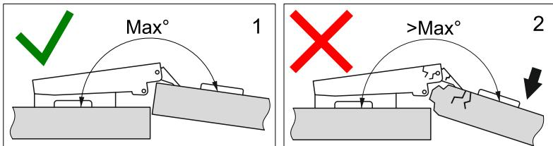
Петли фасада открываются на фиксированный угол (см. схему 1). Открывание фасада на больший угол (см. схему 2) может привести к повреждению деталей и поломке петель.
